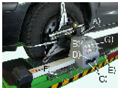
Рис. 2. Рабочая панель датчика стенда FWA 515 (общий план)
